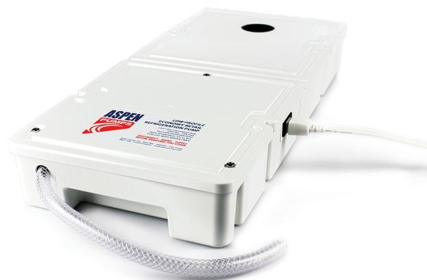
Низкопрофильный насос ERRP (Economical Retail Refrigeration Pump — экономичный насос для холодильных установок, используемых в розничной торговле) в пластмассовом корпусе предназначен для монтажа исключительно под холодильными витринами и обеспечивает отвод воды, образующейся при размораживании, а также загрязненной воды.
