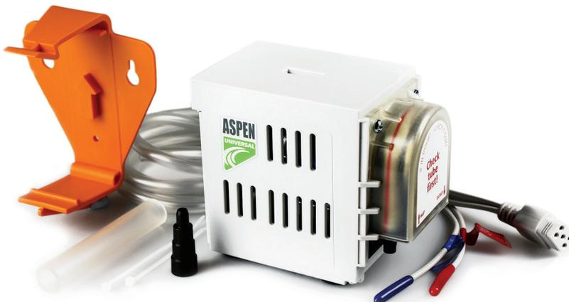
Один из самых продаваемых перистальтических насосов – насос модели Universal – управляется двумя датчиками температуры. Перистальтическое вращательное движение создает постоянную силу тяги, которая позволяет размещать насос на расстоянии до 8 м от источника конденсата без снижения его производительности.
