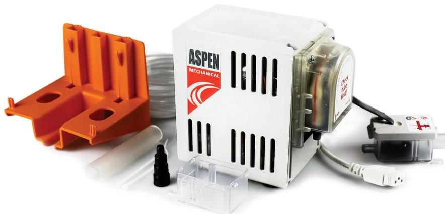
Объединение перистальтической технологии и технологии мини-помп. Просто поместите поплавковый датчик в поддон для сбора конденсата или прикрепите его к патрубку сливной трубки (в зависимости от выбранного резервуара). Доступен вариант с выводом сигнала на отключение кондиционера.
